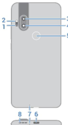
1. Capteur de mise au point automatique laser
