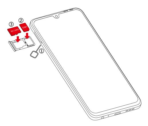
Pour pouvoir effectuer des appels, vous devez avoir inséré une carte SIM. Grâce à la capacité de remplacement à chaud de votre appareil, il n'est pas nécessaire de l'éteindre avant d'insérer ou de retirer la carte SIM.
